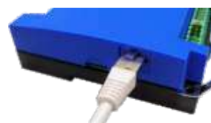
Detalhe do conector RJ45 do EBLOCK para comunicação com o relé (CAN)
