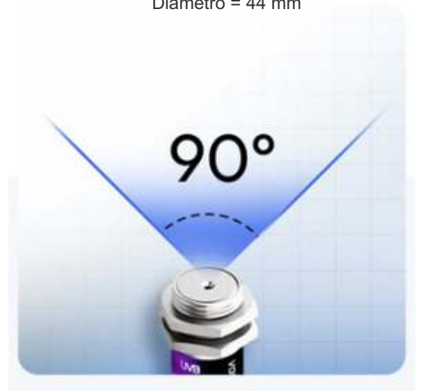
Sensor Arco por Ultravioleta Ampla Área de Detecção (90°) Detecta a grandes distâncias (>7 metros com arco de 200 A / 1 cm)
