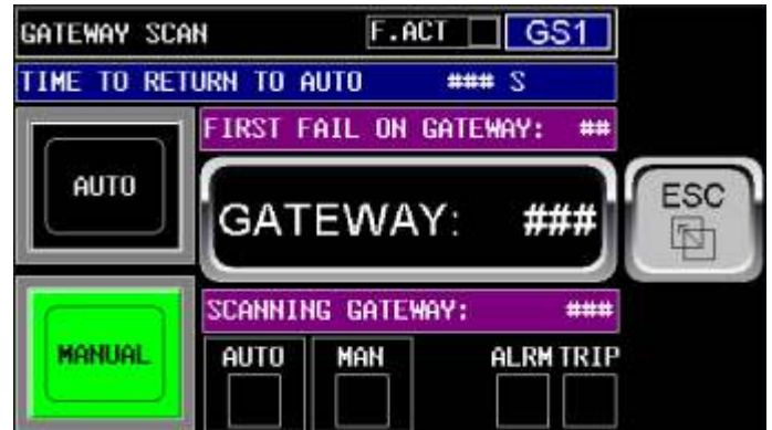
SCAN GS1: Acessada ao se pressionar <SCAN> (Somente na versão Multi Gateway)
