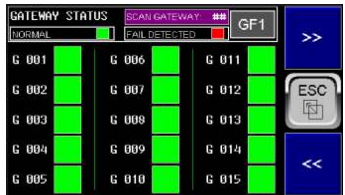
GATEWAY STATUS GF1 a GF3: (Somente na versão Multi Gateways) Acessadas ao se pressionar <MULTI GATEWAY STATUS>
