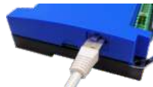
Detalhe do conector RJ45 para comunicação com o relé (CAN)
